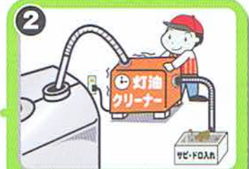
大型ストレーナーで 小サビ・ドロを除去
